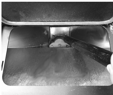
Fig. 24 - Limpieza depósito y coclea
