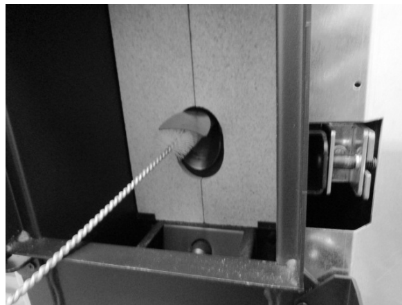
Fig. 23 - Limpieza alojamiento cajón de cenizas
